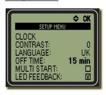
使用していない場合、UniStop は自動的に電源オフします。バッテリーをセーブするため、素早く電源オフにしたいが、通常の作業に影響を及ぼしたくはありません。"OFF TIME"を選択し OK を押すことにより、1分から30 分の範囲で自動電源オフ設定をすることができます。上下のボタンで時間を選び、OK をもう一度押しメインメニューに戻ります。
