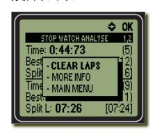
分析モードを操作中、ポップアップメニューを表示させることができます。 MENU ボタンを押すとポップアップメニューが表示されます。もう一度メニューボタンを押すか、左矢印を押すと、ポップアップ・メニューは消えます。 上下のボタン(L4 と S4)を押してメニューを選び、OK ボタンを押します。
