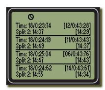
ディスプレイには、各ドライバーの現行ラップタイム、ラップ数、ベストラップと周回数、スプリット数、スプリットタイムとベストタイムが表示されます。
