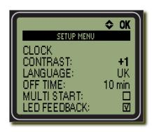
ディスプレイのコントラストとは、点灯したドットと点灯していないドットの明るさの差です。コントラスト設定は、"CONTRAST"を選択しコントラストを手動で調整すつことができます。上下の矢印ボタンを使い調整します。コントラストはー6 から、+6 まで選ぶことができ、同時にコントラストの変化も見ることができます。好みのコントラストになったら OK を押し設定メニューに戻ります。
