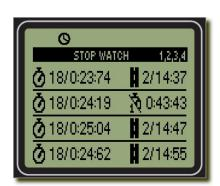
3、4ドライバー計測を頻繁にする方用に、より大きなフォントで表示できる特別モードがあります。この特別モードにするには、UniStopを指導するときに L2 を押し続けます。通常モードに戻すには、始動するときに L2 ボタンを押し続けます。一度特別モードにすれば、次回からも同じモードで立ち上がります。
